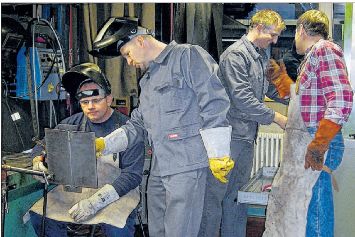
Schweißen will gelernt sein: Technischer Lehrer Pierre Tauberschmidt erklärt Ralf Burkhardt die Technik, mit der man eine Stumpfnahht steigend schweißt. Im Hintergrund sucht Peter Wratschko Elektroden für das E-Hand Schweißen. Foto: Michaela Christ
